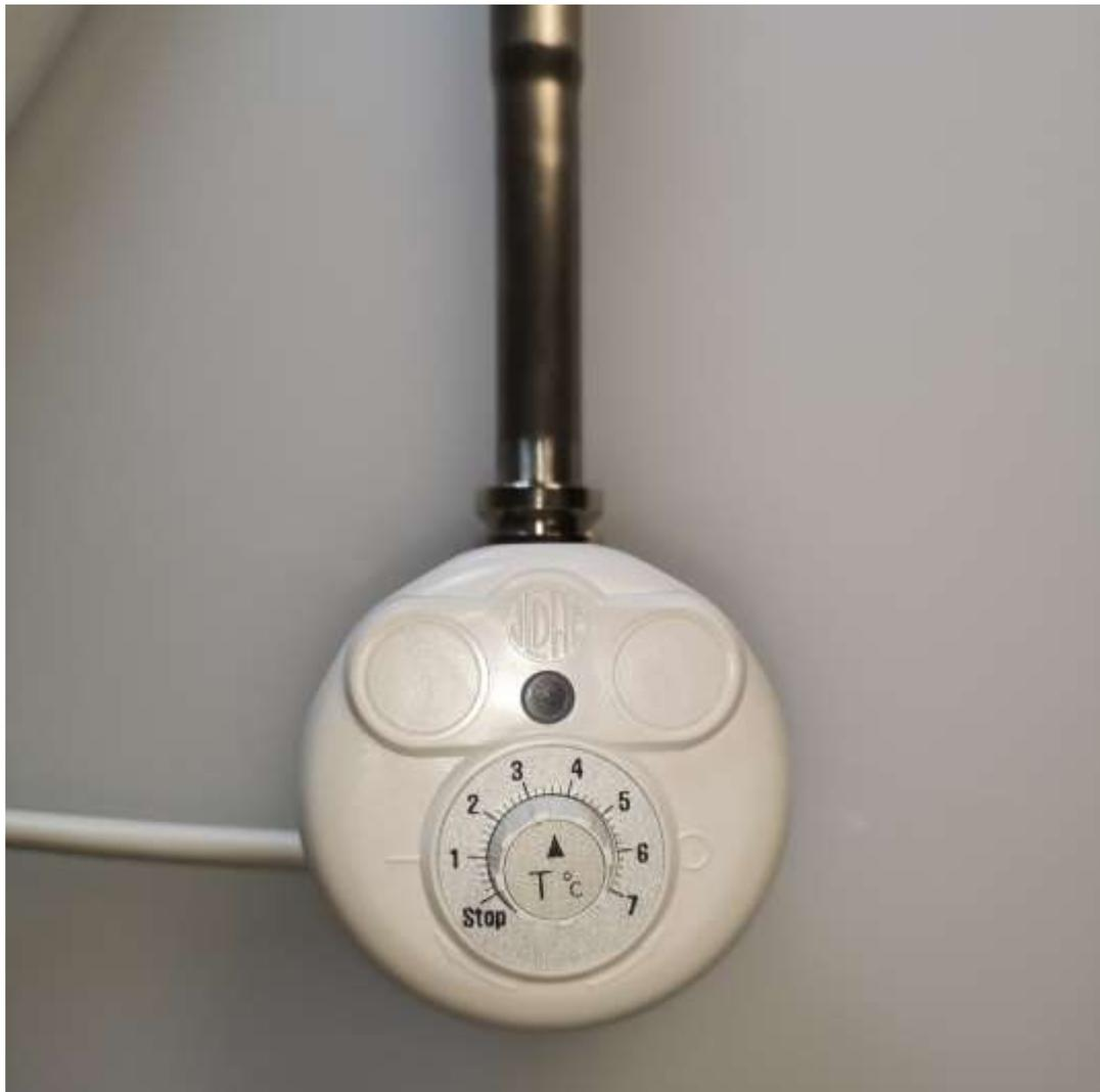
Le modèle Ths JVAPII est destiné à l'équipement d'un radiateur sèche-serviettes raccordé à un réseau de chauffage central ou indépendant de tout réseau. L'insert chauffant doit être monté en position verticale dans le collecteur du sèche-serviettes. Le raccord laiton 1/2" doit être vissé directement dans le radiateur.
