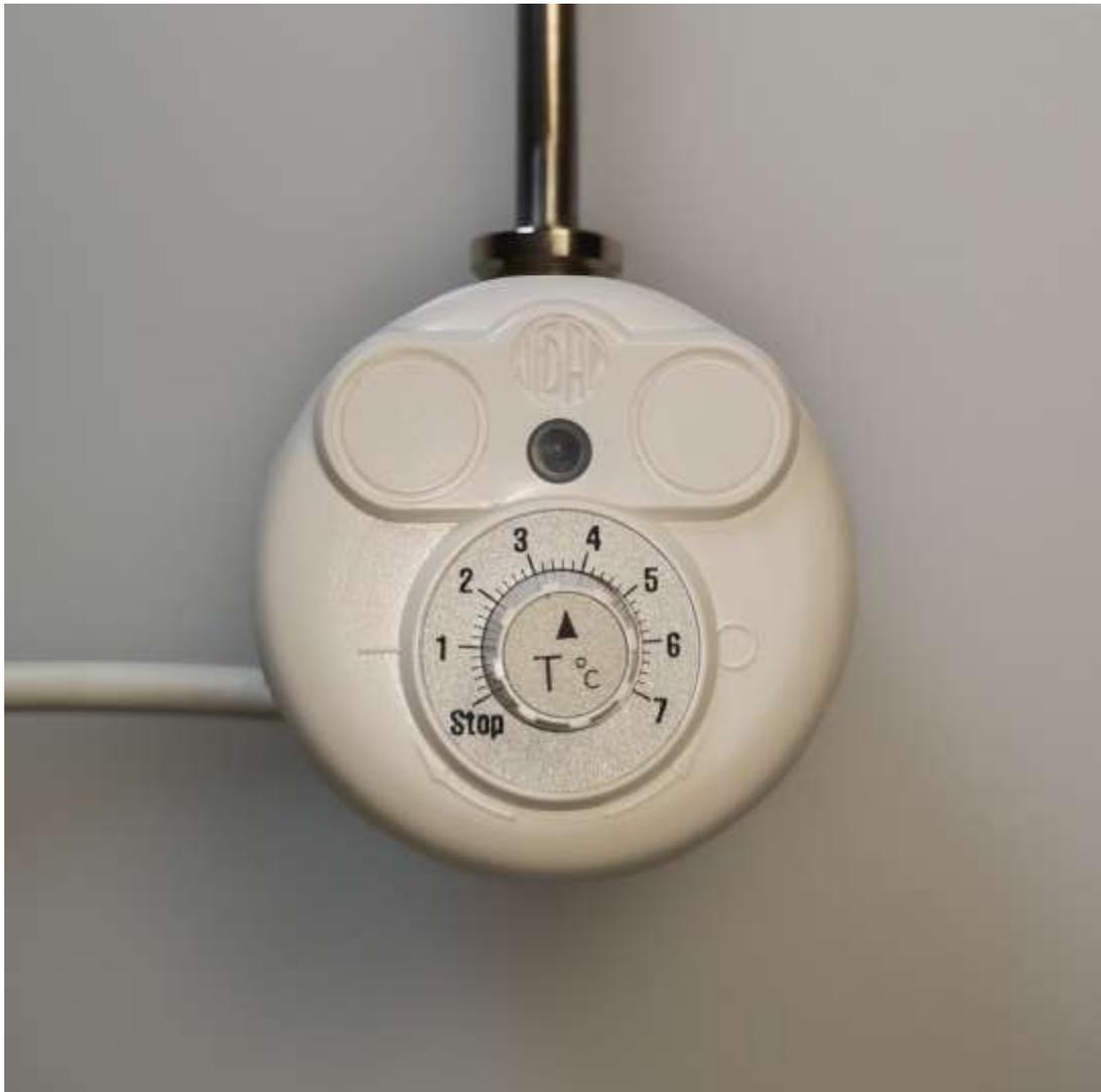
Le modèle JVRLI est destiné à l'équipement d'un radiateur raccordé à un réseau de chauffage central ou indépendant de tout réseau. L'insert chauffant doit être monté en position verticale dans le collecteur du radiateur. Le raccord laiton 1/2" peut être vissé directement dans le radiateur ou sur un T mixte. Le T de retour d'un radiateur sur circuit équipé d'un thermoplongeur doit toujours rester ouvert afin de permettre une libre dilatation du volume d'eau.
